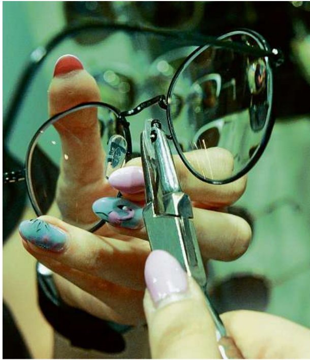
Kaputte Nasenpads einer Brille werden mittels einer Zange durch neue ersetzt. Natalie Scherzberg führt an einem Modell ein Hörgerät ein. Das Ultraschallbad sorgt wieder für eine klare Sicht.
