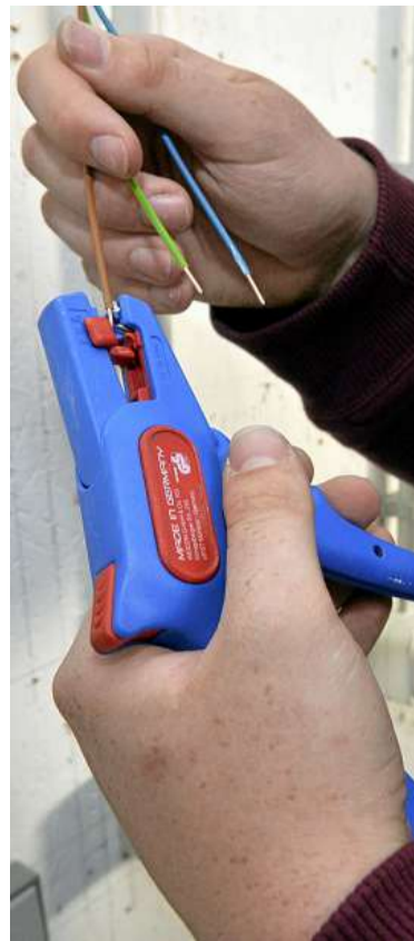
Abisolieren von Kabeln ist Alltag.
